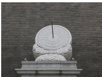
日晷多以石製的圓盤做鐘面，鐘面刻有十二個時辰，每個時辰又分為「時初」、「時正」，即 24 小時。鐘面的中心插有一根銅製的晷針，人們根據晷針投射在鐘面上的影子便可得知時間。鐘面會傾斜地安置在石座上，而鐘面的傾斜角度會由日晷安放的地理位置所決定。
